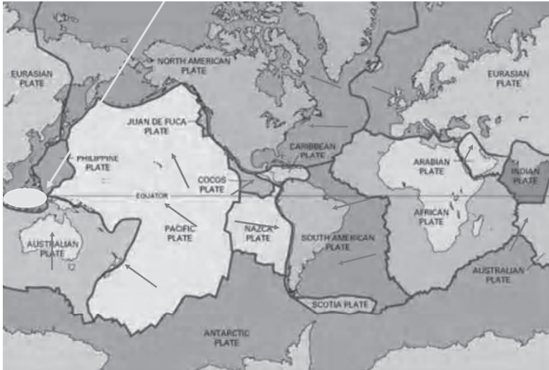
Gambar Posisi Indonesia dalam kedudukan Teori Tektonik Lempeng Arah panah menunjukkan arah gerak lempeng bumi berkisar dari 5 cm/tahun sampai 10 cm/tahun dengan mekanisme gerak saling berpapasan-menjauh dan saling benturan. Sumber : Modul ToTFaslok dan Guru Program CDASC (Muhammadiyah-AusAID),2006.
