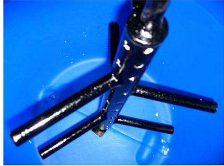
**Gambar 32:** Masih dengan tong plastik serupa, namun aerasi dilakukan dengan menggoyang/memutar komposter. Kerangka yang kuat diperlukan agar mampu menyangga berat sampah organik saat komposter penuh (gambar kiri). Di bagian dalam tong terdapat pipa berlubang dan pemecah gumpalan sampah agar aerasi berjalan lebih optimum dan air yang berlebih dapat dikeluarkan (gambar kanan). Komposter ini dipasang di kolong tol dan digunakan oleh masyarakat di Penjaringan, Jakarta.
