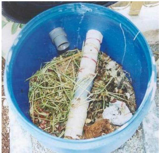
**Gambar 31:** Menggunakan tong plastik berukuran 120L yang dilengkapi pipa vertical dan horizontal agar proses berlangsung secara aerob (dengan udara). Salah satu pengguna komposter jenis ini adalah masyarakat di Jambangan, Surabaya.
