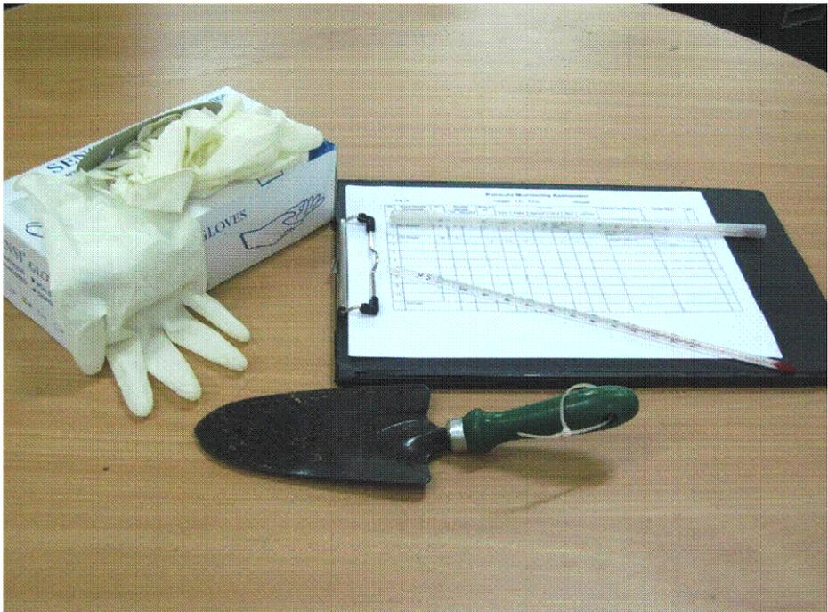
**Gambar 38:** Peralatan monitoring komposting yang terdiri dari termometer, sarung tangan karet, sekop, dan tabel/formulir monitoring
