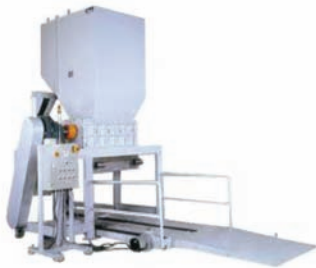
Gambar 4.4. Mesin Pencacah Sampah (terdapat di fasilitas pengolahan sampah)
