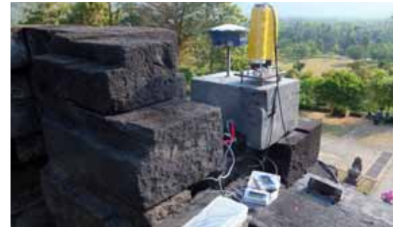
Pemantauan struktural menggunakan GPS dan inklinometer digital.
